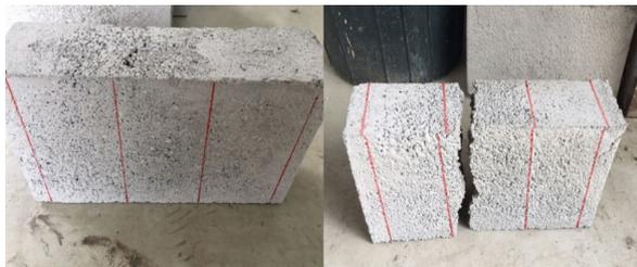
Figura. 2. Ensayo de flexión
