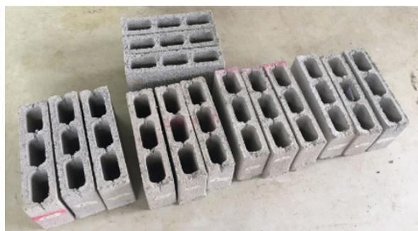
Figura 1. Probetas para ensayos de compresión y flexión
