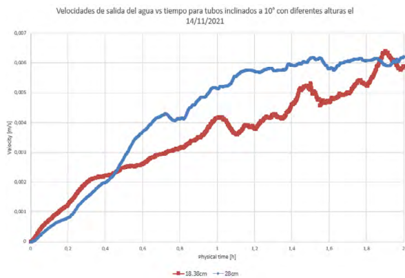
Figura 4. Velocidades de salida del agua para tubos a 10° y mayor altura el 14/11/2021.
