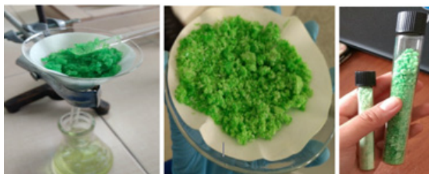
Figura 4. Filtración, secado y almacenado del compuesto de coordinación obtenido: trioxalatoferrato (III) de potasio.
