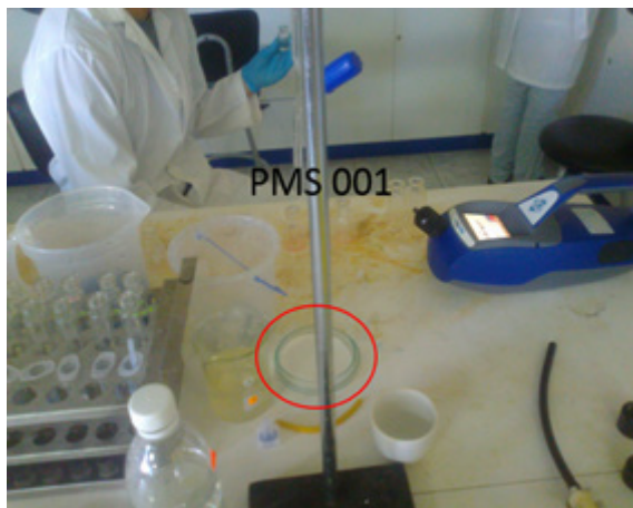
Figura 3. Recolección de Material Particulado Sedimentable en cajas Petri (MPS 001; MPS 002) en el LSA-UNACH.
