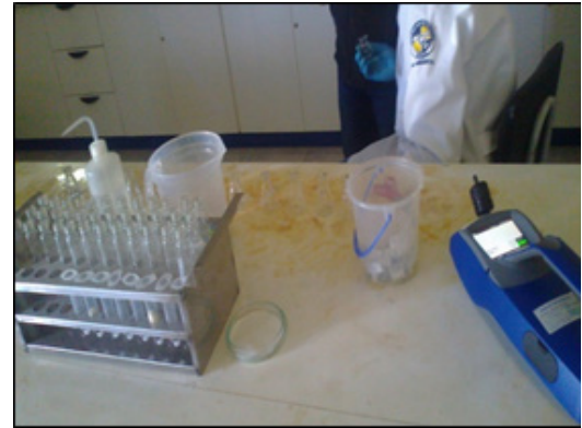
Figura 2. Recolección de Material Particulado Atmosférico con el equipo DustTrak™ II en el LSA-UNACH
