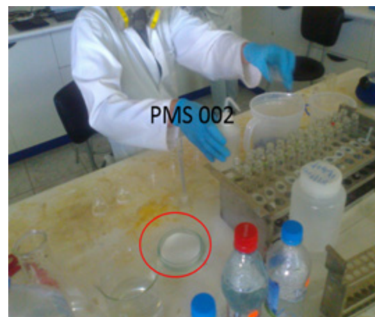
Figura 3. Recolección de Material Particulado Sedimentable en cajas Petri (MPS 001; MPS 002) en el LSA-UNACH.
