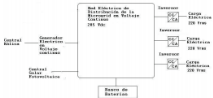
Figura 3: MG desconectada a red eléctrica.
