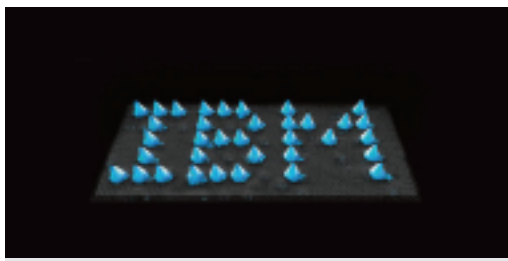
Figura 1. Logo de la IBM formado por 35 átomos y visualizado con el uso de un microscopio de fuerza atómica [1].
